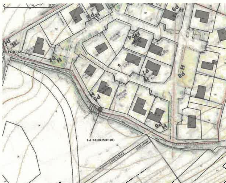
Figure 11 – Implantation des sondages à la pelle, Coulais Consultants 2008, recalé sur le cadastre actuel ; le point noir est un repère de nivellement, le rectangle hachuré l'indice de marnière.
